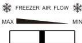
Odhad množství potravin, které má být zmrazeno. Při mrazení velkého objemu potravin nastavte ovladač teploty na nízkou úroveň čímž se sníží teplota v mrazničce.
