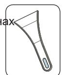
видаляти. За необхідності використовуйте пластиковий скребок. Не використовуйте для цього гострі металеві предмети. Так ви можете проткнути контур холодильника, і це приведе до невіправного пошкодження приладу.
